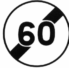
81- انتهاء حد السرعة End of Speed Limit Fin de limitation de vitesse
