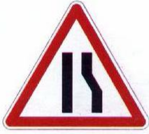
9- الطريق يضيق من اليمين Carriageway Narrows to the Right Rétrécissement de la chaussée à droite
